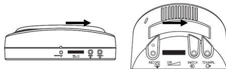
本体背面の電源付ボリュームをカチッという音がするまで右(左図矢印方向)に回して電源をONにします。
